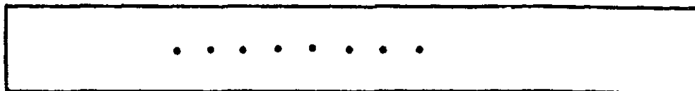
Пример 6: восемь дефектов диаметром по 0,8мм
