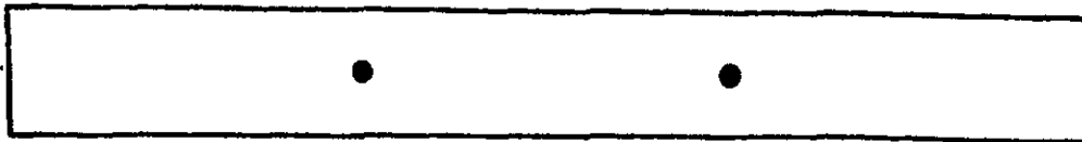
Пример 1: два дефекта диаметром по 3,2мм
