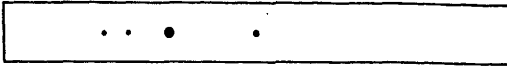
Пример 2: один дефект диаметром 3,2мм; один-1,6мм; два по 0,8мм
