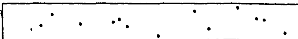
Пример 8: три рассеянных дефекта диаметром по 0,8мм; десять по 0,4мм
